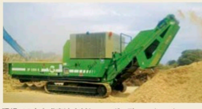
現場での自走式高速木材シュレッダーデモンストレーション
