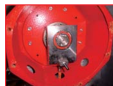
【刃の損傷を最小限に抑えるローター自動停止装置】
