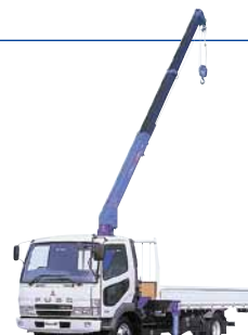
クレーン付トラック (2~4t)
