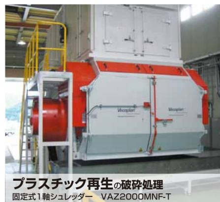
プラスチック再生の破碎処理
