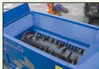
強力破碎ローターにより原料をスムーズに破碎します。
