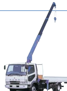
クレーン付トラック (2~4t)
