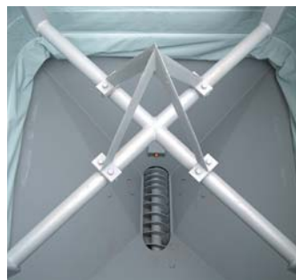
固化材ホッパ内部の スクルーフィーダ
