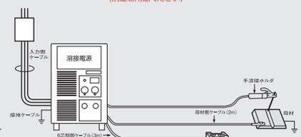
※1 CBT-EX(直流低スパッタ)モードを選択する際は、溶接機(WB-M352L/P352L/P502L)付属の電圧検出ケーブルK5791G00(5m)をご使用ください。
