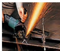
切断トイシによるアングル切断作業
