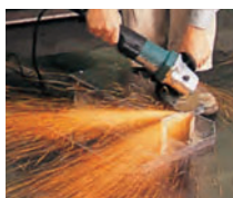
レジノイドフレキシブルトイシによる研削作業
