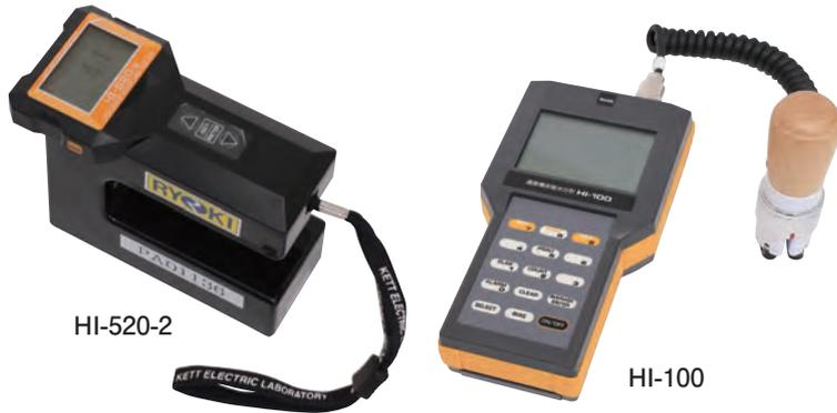
本体を対象物表面に当てるだけで含水率を測定。硬化コンクリート、モルタル、ALCなどに使用、迅速に測定結果をデジタル表示します。
