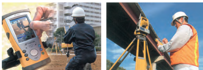
イメージワンマンで観測・誘導が自由自在 視準位置を手元で確認・測定可能
