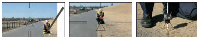
視準したい場所をペンでタップ IS3本体が旋回し、自動視準 プリズムロック
