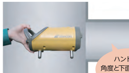
小型マンホール/管内への設置
